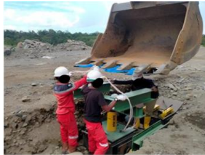
Gambar 3. Instalasi balok reaksi vertikal dan pelat baja tanam
